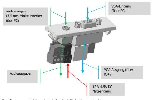
Empfänger – wird hinter oder in Nähe des USB-Gerätes positioniert
